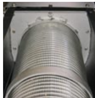
Die Läckeby Products Schneckenpresse ist mit einer Inspektionsklappe über der Presseneinheit ausgestattet. Das Pressenrohr ist austauschbar.
