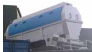
En WSP-260 skruvpress kopplad till en RotoSieve® RS-416 Trumsil ger optimal avskiljning av rens.
