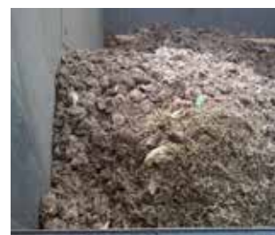
Avfallet från en WSP skruvpress har en torrhalt på över 50%.
